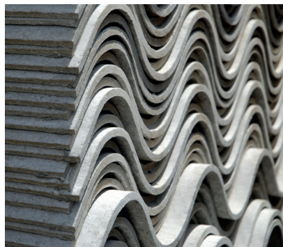
płyty azbestowo-cementowe tzw. eternit
