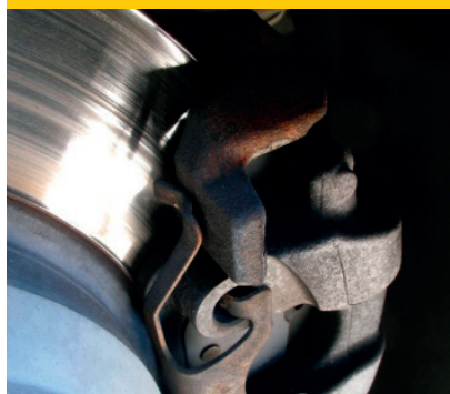
tarcza z klockami hamulcowymi zawierającymi azbest, jako przykład zastosowania azbestu w przemyśle motoryzacyjnym
